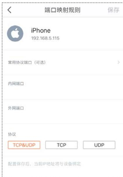
设置完成后，互联网用户使用“内网服务应用层协议名称://穿墙宝设备 WAN 口 IP 地址:外网端口”可以成功访问局域网服务器。
